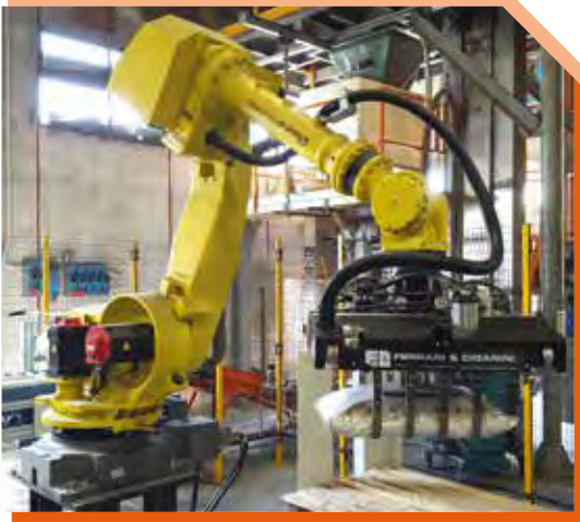
Robot palletizzatore per sacchi Palletizer robot for sacks Robot paletizador para sacos Robot palettiseur pour sacs
