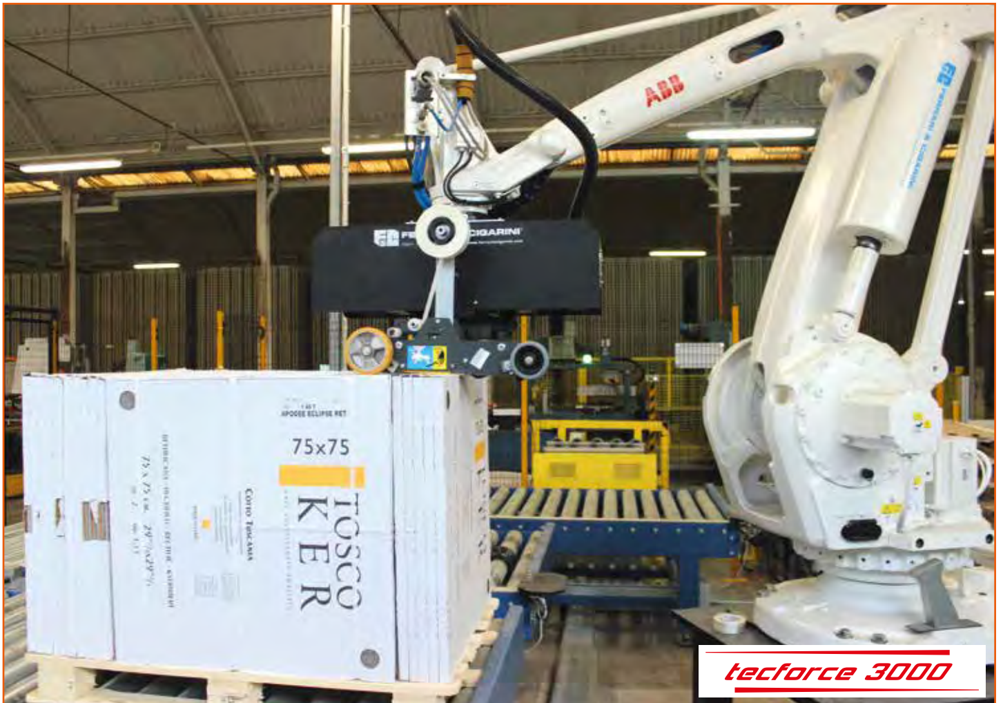
Robot palletizzatore con nastratrice Palletizer robot with taping unit Robot paletizador con precintadora Robot palettiseur avec enrubanneuse
