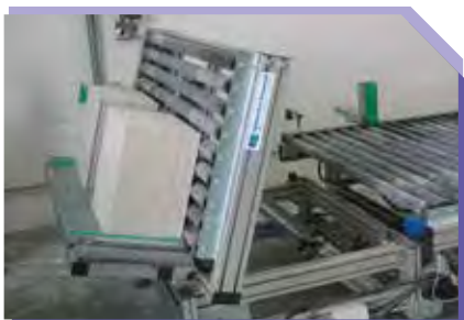
Ribaltatore automatico per carico di formati medio-grandi Motorized tipping device for loading of medium/large formats Volteador motorizado para cargar formatos medios/grandes Basculeur motorisé pour charger les formats moyens/grands
