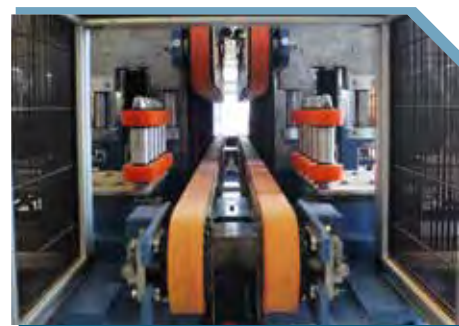
Centratore e Gruppo pressore a cinghie sincronizzate Centring device and Roller unit with synchronized belts Centrador y Grupo presor con correas sincronizadas Centrateur et Unité de pression avec courroies synchronisées
