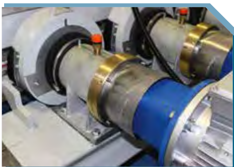
Mandrino calibratore a secco Dry calibrating-spindle Mandrill calibrador a seco Mandrin calibreur à sec
