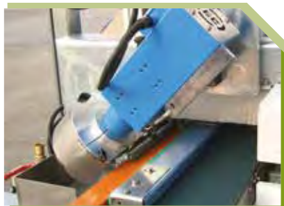
Testa bisello inferiore Head for inferior bevel Cabezal para bisel inferior Tête pour biseau inférieur
